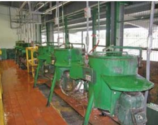
Máquinas usadas para la remoción mecánica del mesocarpio en la nueva y moderna Unidad de Procesamiento de Semillas en Coto.
